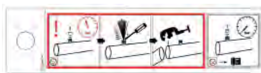
940 - Warnhinweis "Transportfüllung" am Schraderventil
